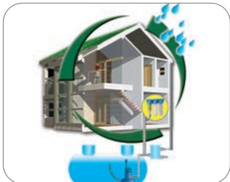
Pré-filtre autonettoyant avec contre-lavage et cartouches exclusives: **RAH** métallique en acier inox 90 microns; **RLH** en plastique 90 microns; **RSH** plissée en plastique 50 microns.
