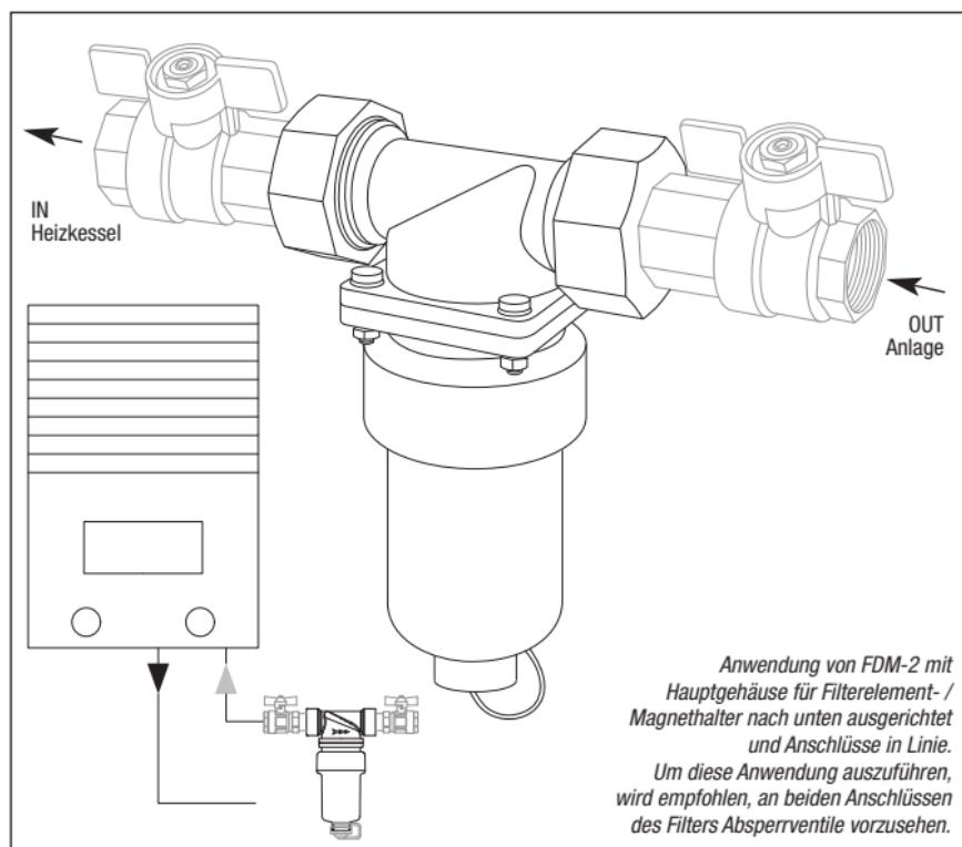
**ACHTUNG:** Der Filter FDM-2 enthält starke Magneten.
