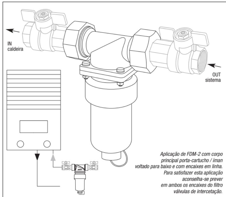
*Aplicação de FDM-2 com corpo principal porta-cartucho / íman voltado para baixo e com encaixes em linha. Para satisfazer esta aplicação aconselha-se prever em ambos os encaixes do filtro válvulas de intercetação.*
