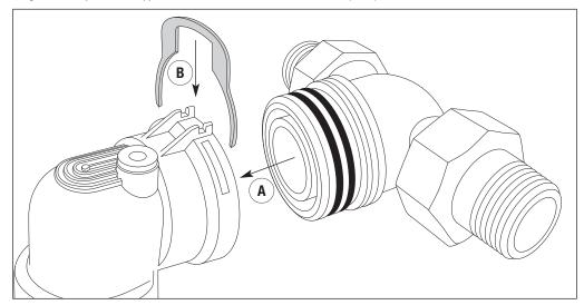
FDM-3 va installato rispettando il senso di flusso indicato dalla freccia riportata sul tee di raccordo, e con corpo sempre in
