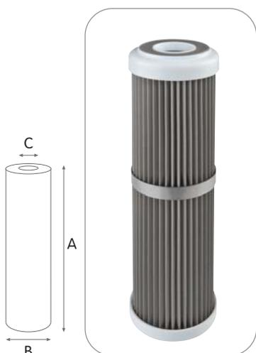
Cartucce in rete di acciaio inox plissettato, con nucleo centrale in polipropilene, filtrazione nominale 50 micron.
